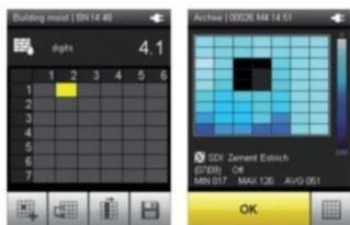
Definer blot målepunktet der skal evalueres på gitteret og det konfigurerede net vil blive vist på displayet. Nu skal du bare arbejde dig igennem gitteret ved at måle i de ønskede punkter. Alle målte data gemmes automatisk i T3000 i den rigtige rækkefølge.
