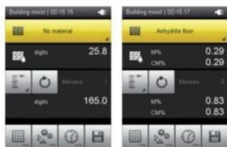
vejledende måleresultat direkte i masse- og CM% på displayet af T3000. Den integrerede konvertering af måle-resultater er et praktisk værktøj, til hurtigt at kontrollere om der er klar til gulvlægning eller videre behandling.
